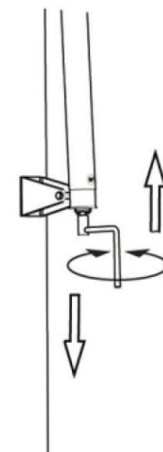
Рукоятку (R) можно снять. Она крепится небольшим болтом (Z1), расположенным на конце механизма регулировки (Z).
