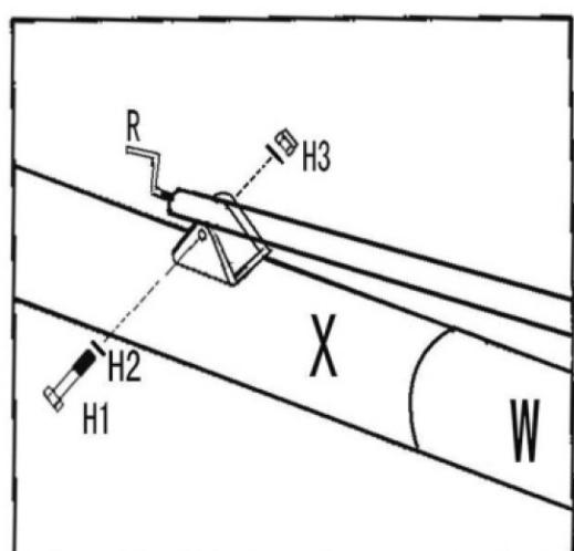
Прочно затяните гайки.
