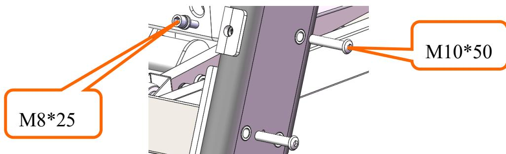
3. Установите консоль на стойки и зафиксируйте ее при помощи ключа под внутренний шестигранник 6# и винтов M8\*25 (не затягивайте винты до конца).
