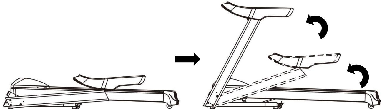
2. Установите стойки на основание и зафиксируйте их при помощи ключа под внутренний шестигранник 6#, винтов M10\*50 и винтов M8\*25, как показано на рисунке ниже (не затягивайте винты до конца).
