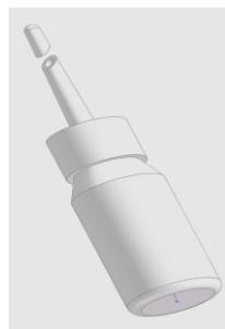
С. Выдавите силиконовую смазку из отверстия (не более 90 мл, иначе смазка перельется через край). Уберите емкость.
